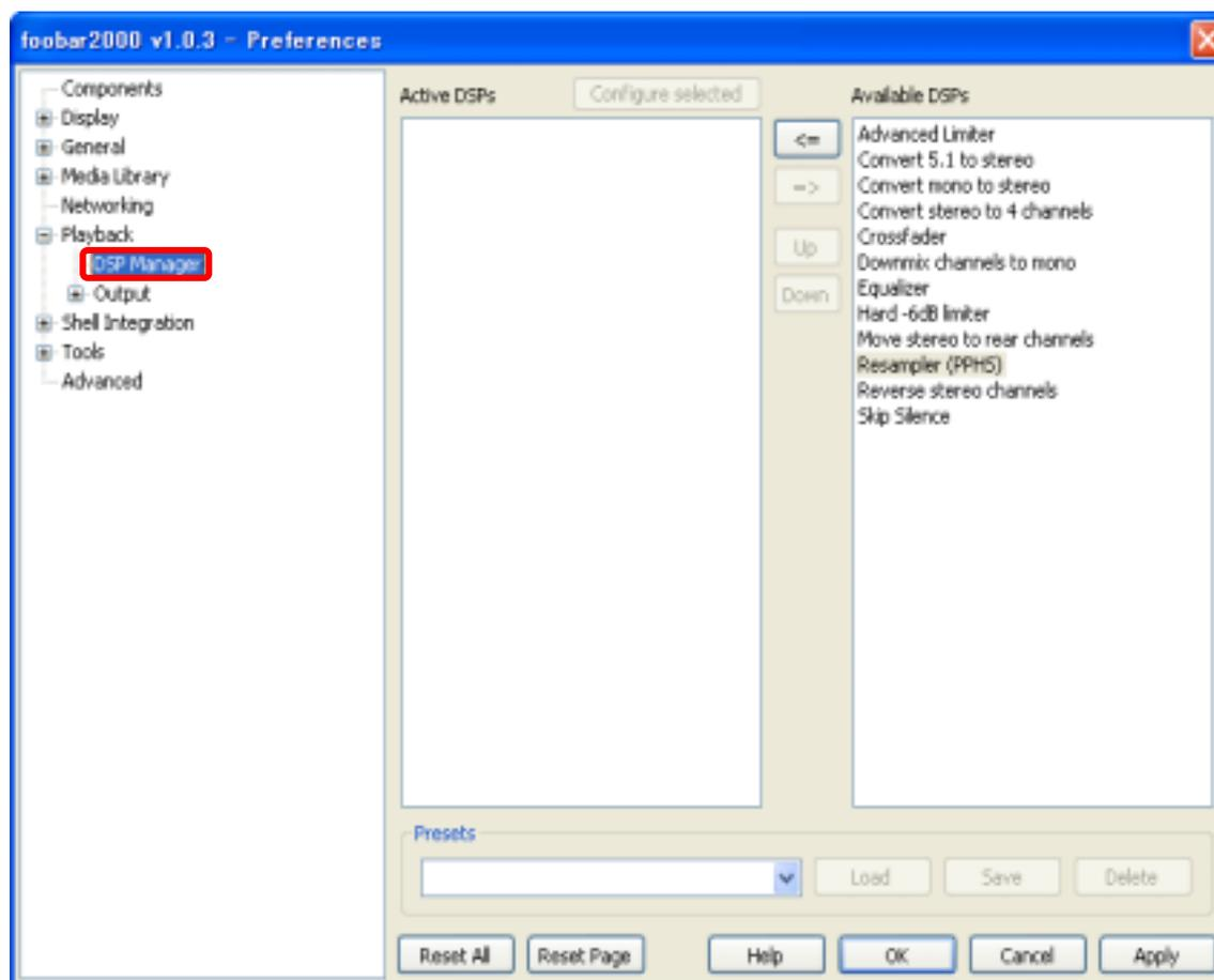
7. Available DSPs の [ Resampler (PPHS) ] を選択し、[ < = ] ボタンを押します。
