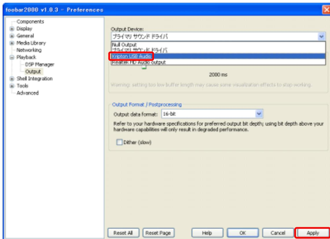
4. Output Format / POSTprocessing の " Output data format : " の [ 24bit ] を選択し、[ OK ] を押して設定完了します。
